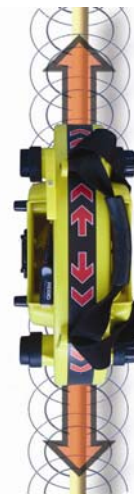
Рис. 8: Ориентация относительно коммуникации в индукционном режиме
